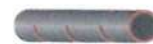
CANALISATIONS RIGIDES Ø100mm AVEC OUVERTURES Ø 10mm OU FENTES DE 5mm minimum ESPACES TOUTS LES 10 à 15cm
